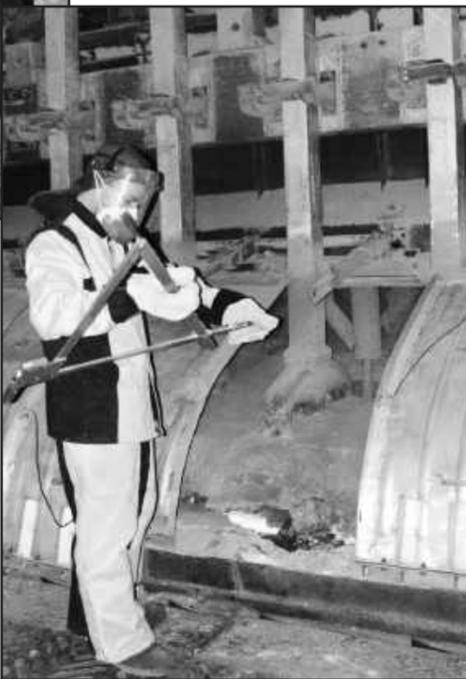
успешно выполняют замеры уровня металла и электролита на четырех электролизерах больших серий. Конечно, им приходится выполнять максимальный объем работы, потому как необходимо произвести за смену 80 с лишним замеров на почти таком же количестве электролизеров.
